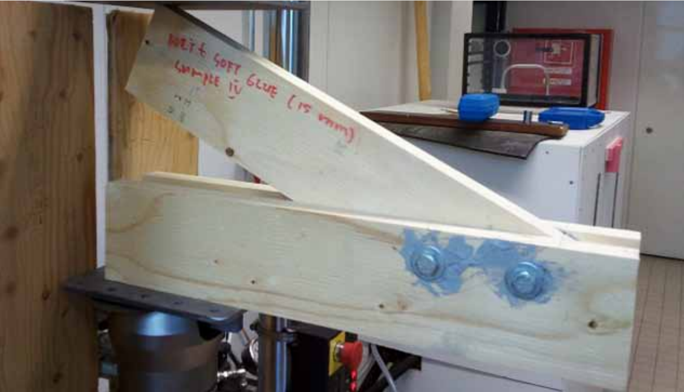
Stresstest för imitation av trollsländans vingmekanism. Foto: Parvez Alam.
