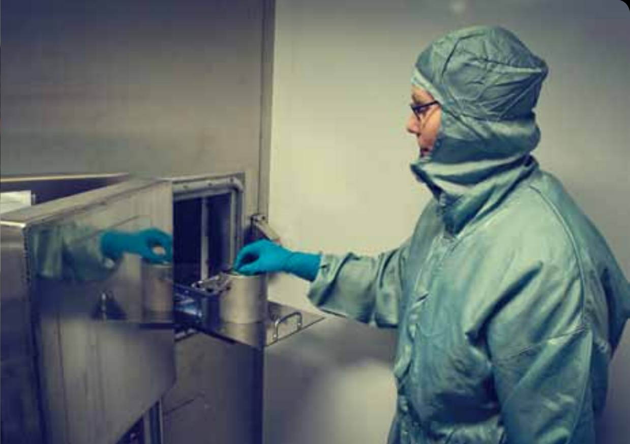
Sarita Forsback i sitt dagliga arbete i produktionen av FDG. Isotoperna levereras från acceleratorbunkern upp till en hot cell (blyskåp) på andra våningen för att manipuleras så att de kan användas inom radiomedicinen.
